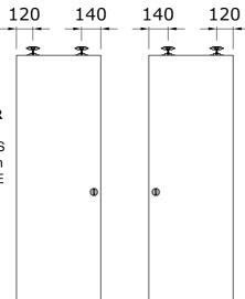
**N.B.:** PLACE THE DOOR-GUIDE ON THE FLOOR AT 10 mm FROM THE FRONT JAMBS BY USING THE DOUBLE VERTICAL ELEMENT OF THE DOOR-GUIDE
